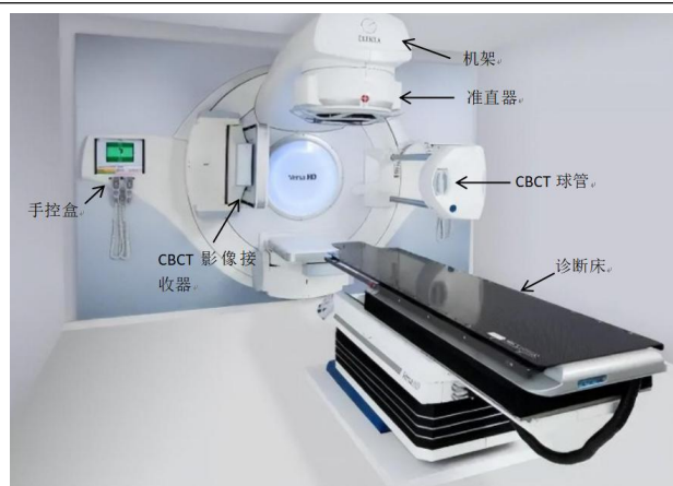
图 9-6 常见的医用电子直线加速器结构示意图
